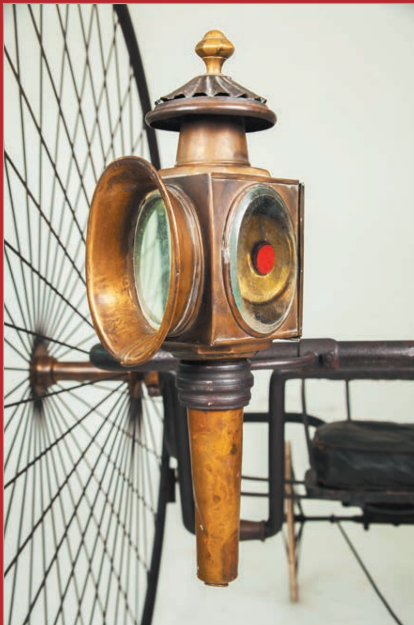
Exemple d'une des deux lampes à bougie équipant un quadricycle Vélocimane Delisy du musée Vélo Moto de Domazan.
